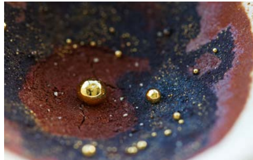
Durch Biolaugung extrahiertes Gold aus einer metallurgischen Schlacke (Urban Mining)
